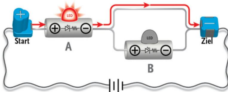
Paralleles Signallicht mit abzweigendem Metallstreifen in einer Reihe mit einem anderen Signallicht – Signallicht A wird aufleuchten, Signallicht B bleibt aus
