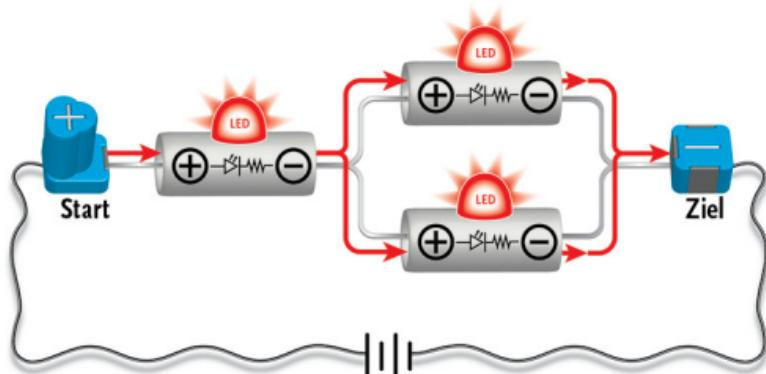
Reihensignallicht mit zwei parallelen Signallichtern – alle 3 leuchten auf
