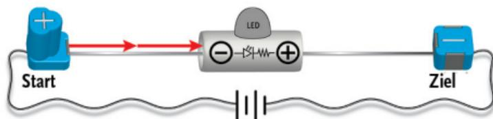
Gegen den Stromfluss ausgerichtetes Signallicht
