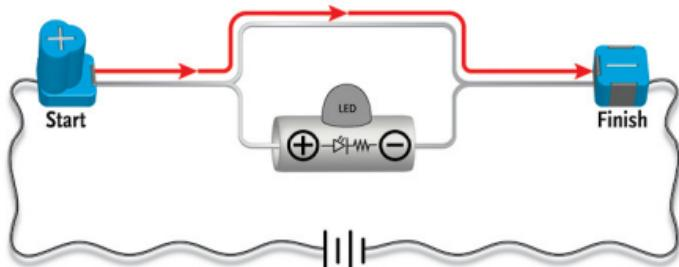
Segnale luminoso su un circuito in parallelo con diodi di Bypass
