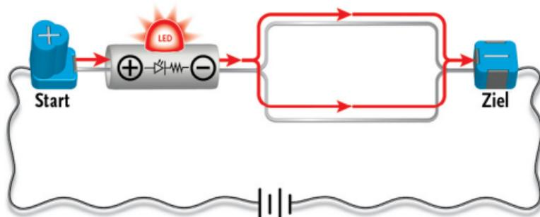
Parallele Metallstreifen in Reihe – Das Signallicht leuchtet auf
