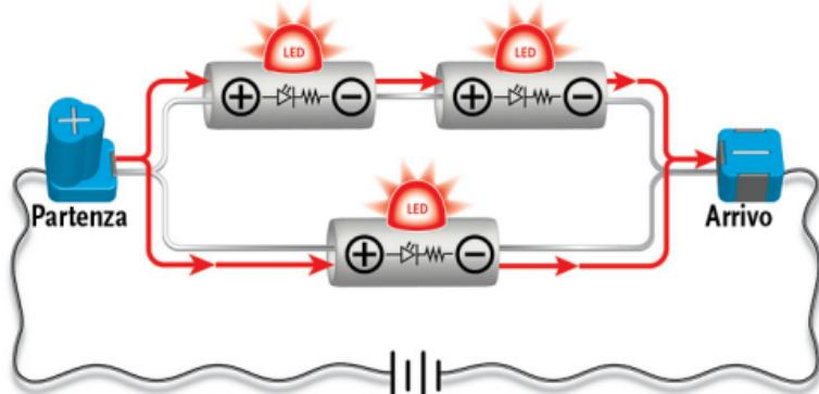
Due segnali luminosi in serie che sono in parallelo con il terzo segnale luminoso. Tutti i segnali luminosi sono accesi
