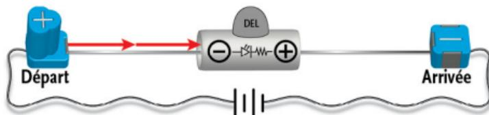
Balise à DEL orientée dans le sens contraire (à contre-courant) du courant électrique
