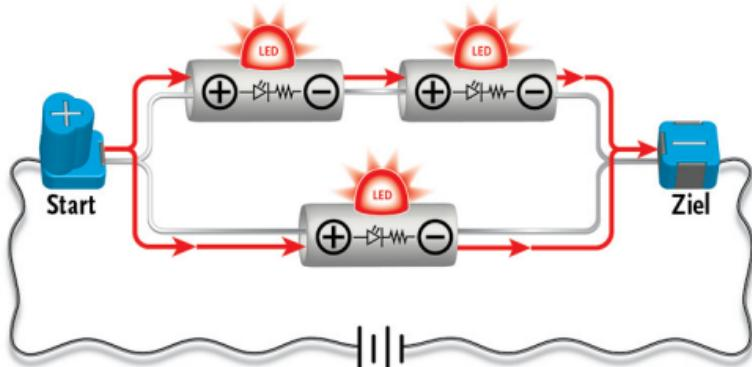
Zwei Reihensignallichter mit parallel angeordnetem dritten Signallicht – alle 3 Signallichter leuchten auf.
