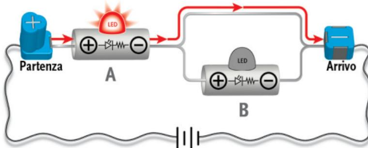
Segnale luminoso in parallelo con diramazione sulla quale è posizionato un altro segnale luminoso – il segnale luminoso A si accende , il segnale luminoso B resta spento
