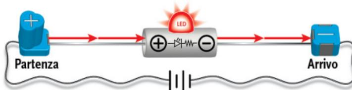
Segnale luminoso LED ben orientato per fare passare il flusso di corrente
