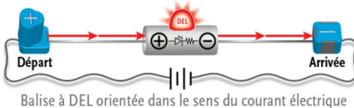
Comme montré dans le diagramme suivant, si la balise à DEL est inversée, de façon telle que la borne négative (-) soit dirigée vers la pièce Départ (+), le dispositif (valve) de la DEL se referme et le courant ne traverse pas la DEL : la balise demeure éteinte.
